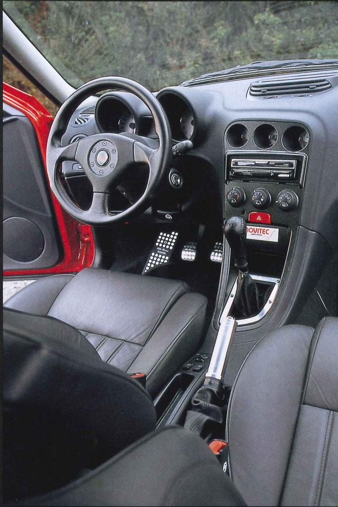
室内でノヴィテックのオリジナルとなる部品は、アルミ製ハンドブレーキレバーとアルミフレーム付きのギアシフトブーツ、アルミ製ペダル&フットレスト、アルミ製ドアロックノブ。カーベットも同社のロゴ入り。MOMO製レザーシートは20万円のオプションだ。
